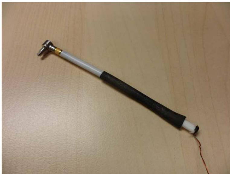
**Fig. 3.9** Impact Hammer Model 086E80
