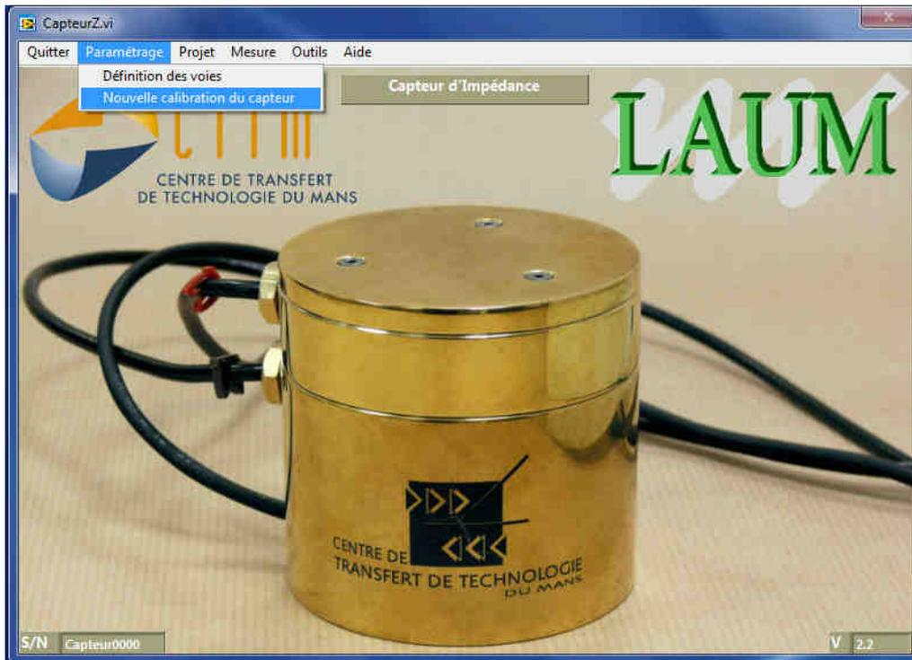
Figure 7 : menu « Nouvelle calibration du capteur »
